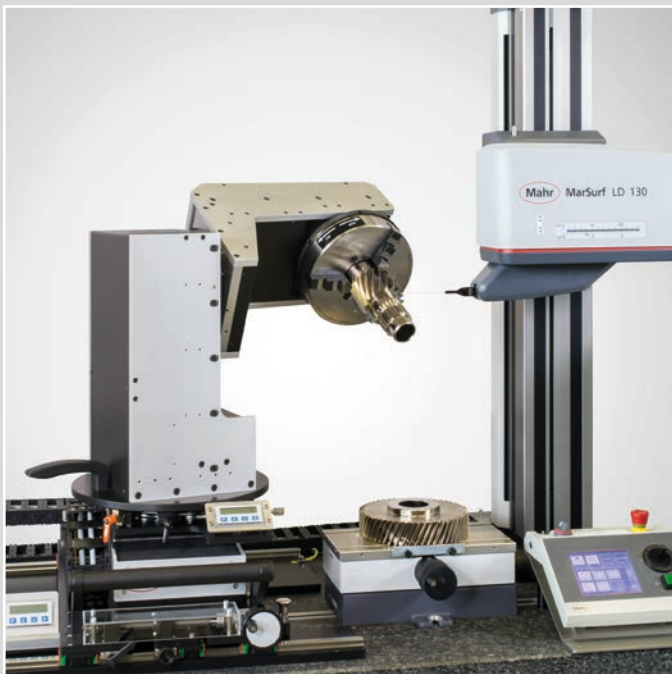
Einfache Positionierung der Zahnflanken
